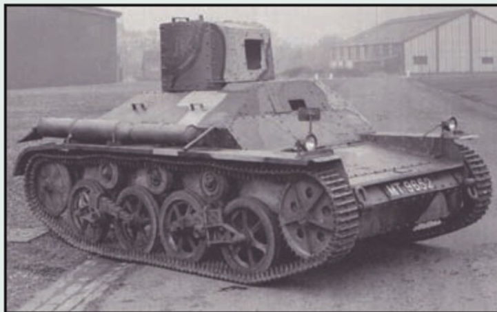
De Lichte Tank IA (A4.E6), hier zonder machinegeweer. De lange uitlaatpijp hoort bij de Ricardo dieselmotor. Het camouflagepatroon is in groen, zand en grijs, gescheiden door zwarte lijnen.
